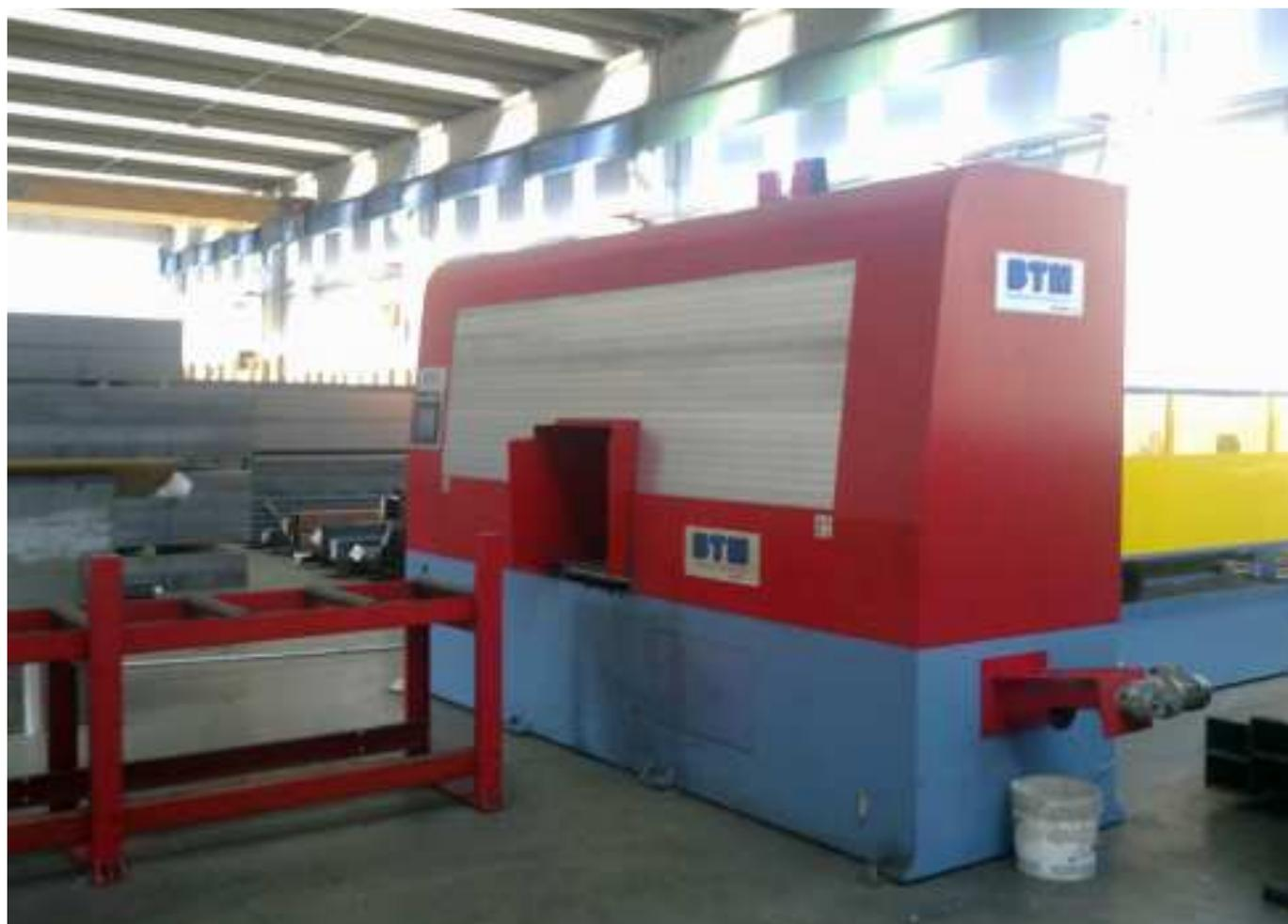
Segatrice a nastro automatica BTM B 620 CNC corsa carro 3000
